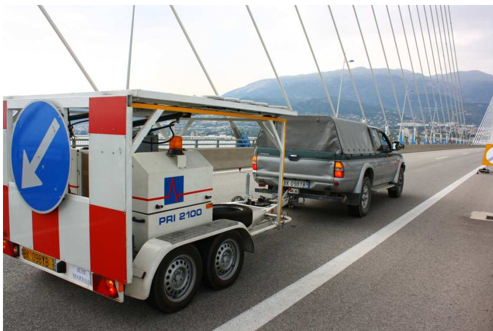
Figura 2: strumentazione FWD di Elletipi S.r.l.
